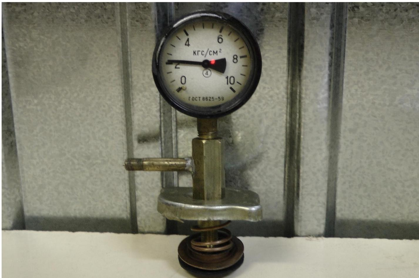
**Конструирование:** прибор для проверки бензонасосов на двигателе
