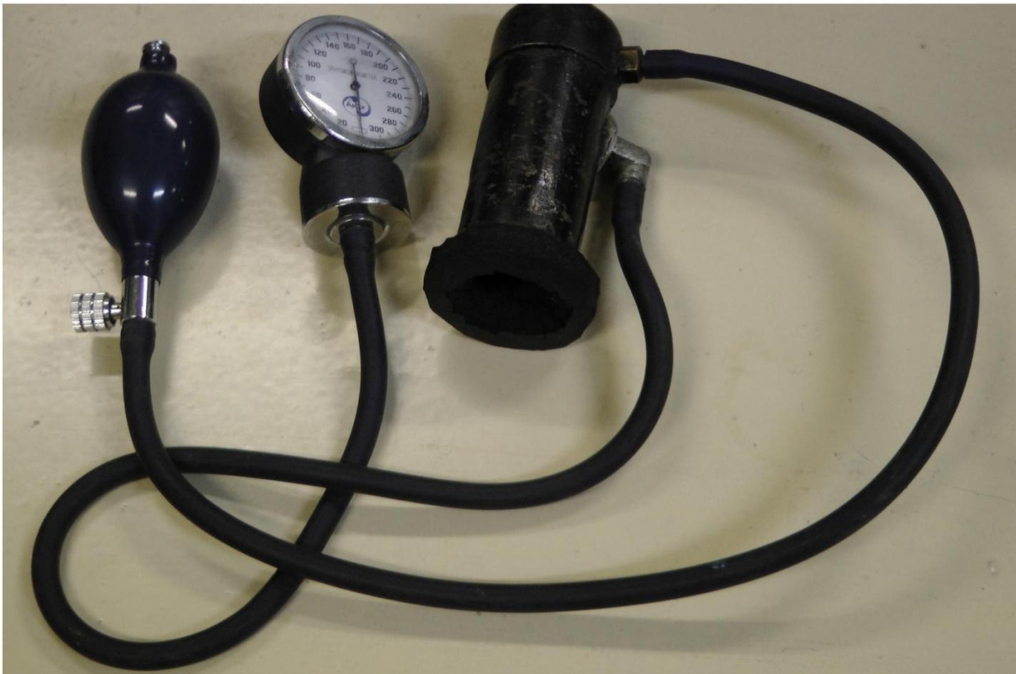
**Конструирование:** прибор для проверки клапанов крышки радиатора
